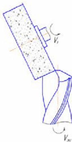
Рисунок 7 - Заточування свердла периферією круга 0,1-0,3 мм.
